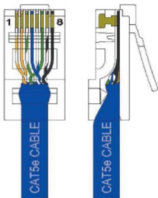
Il sistema di connessione accomuna tutti i dispositivi FilaVia ed è costituito dal connettore RJ45 e dal cavo Cat5 o Cat6 il cui cablaggio venga realizzato secondo lo standard UTP EIA/TIA – 568B.
