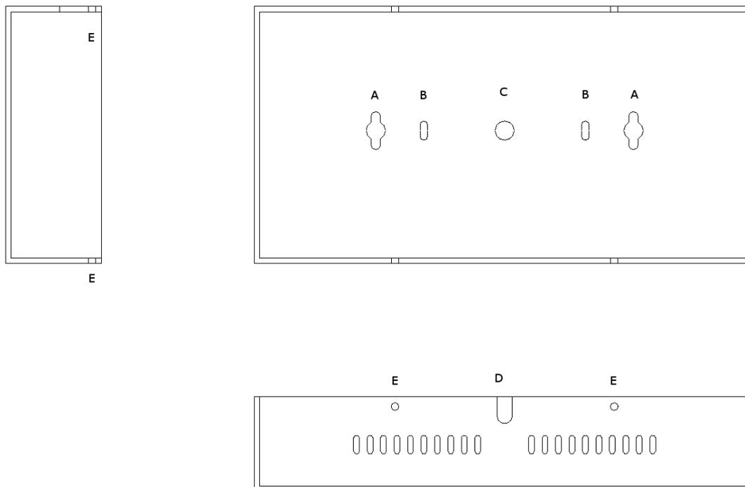
Per fissare il display al muro è necessario, per prima cosa, aprire la scatola in plastica tramite le viti segnate in figura con la lettera E. A questo punto esistono due modi per effettuare il fissaggio al muro. Il primo con viti e tassello ad espansione facendoli passare dai fori segnati con la lettera A, il secondo avvalendosi di una scatola T503 eventualmente predisposta nel muro utilizzando i fori segnati con la lettera B.
